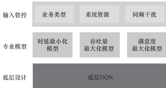
图10 多智能体模型结构
